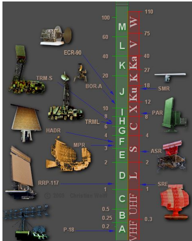
Ilustración 4: Ejemplos de radares y frecuencias asignadas. Fuente: Christian Wolff
