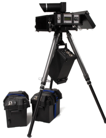
Ilustración 8: Vista general del sistema radar (14)
